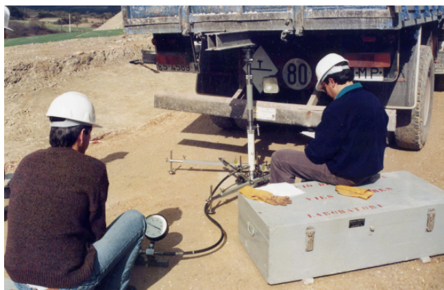
Assaig de placa de càrrega a Savallà del Comtat per comprovar la resistència de la base de la nova carretera, per part del laboratori de materials de la Diputació. Autor desconegut. Any 1994. AGDT 0049401.
