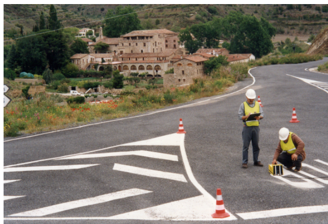
Assaig de pintura horitzontal a l'accés a Escaladei per part del laboratori de materials de la Diputació. Autor desconegut. Any 1994. AGDT 0049399.
